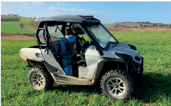
ATV/QUAD Corteva con campionatore automatico e software di georeferenziazione
